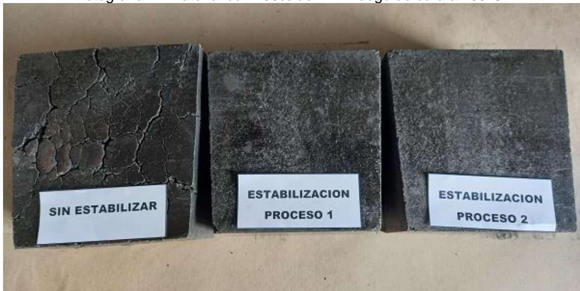
Fotografía 2: Material con 100% de MPR luego de cura a 200°C.
