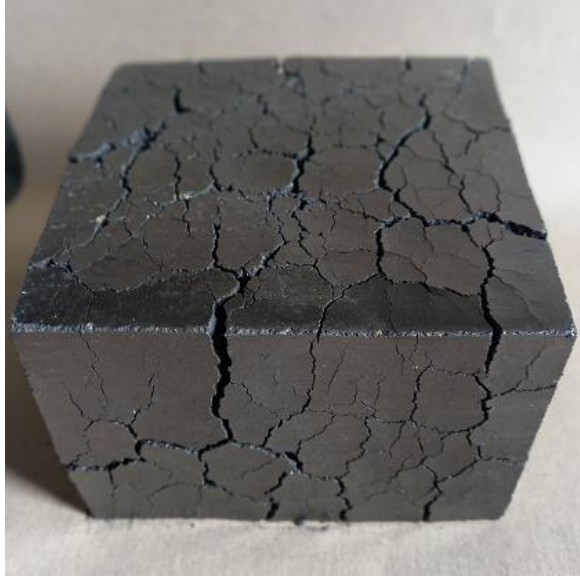
Fotografía 1: Efecto del Al_4C_3 sin estabilizar.
